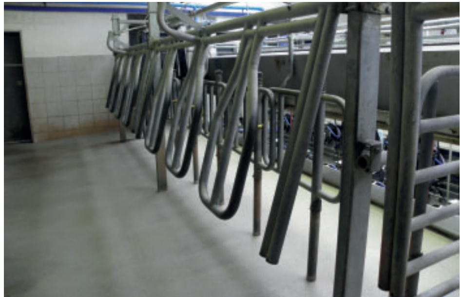
Melkstand 2x8 vom Typ Side by Side mit Frontauslaß.
